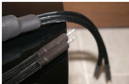
▲根據CFM的介紹，OnEarth技術重點在於為屏蔽層提供一個接地端，同時成為整套系統的接地參考點。
