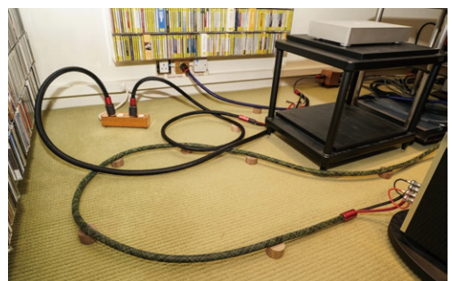
▲終極匯龍之選，入牆電源插座地線接Melodious OnEarth地線，在OnEarth地線的尾巴，再接一條Melodious Earth地線至「金盒」，形成地中地的接法！
